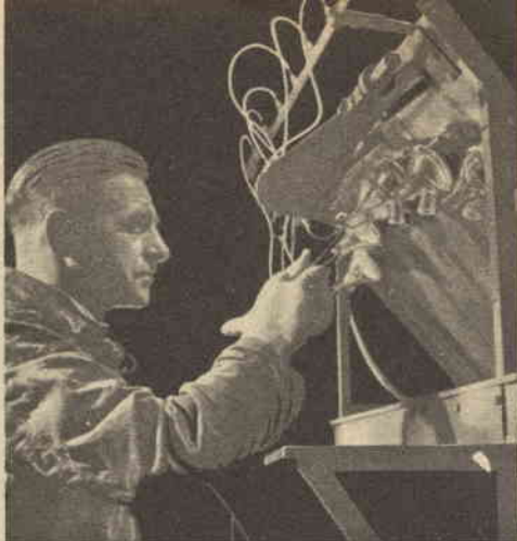
Applicazione per spruzzatura di fosfori in tubi a raggi catodici. Tale applicazione richiede grande attenzione e esperienza.
